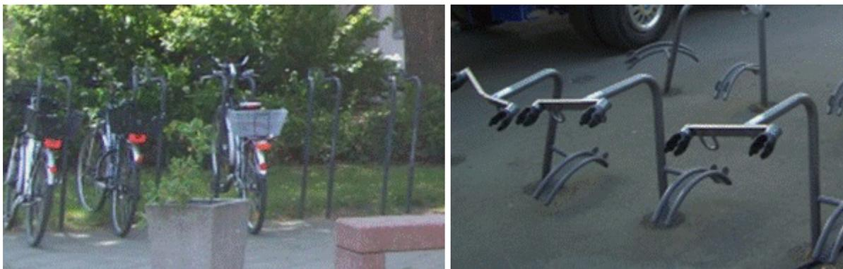
Abb. 10: Fahrradständer in Jena – Lenkradhalter und Rahmenhalter
