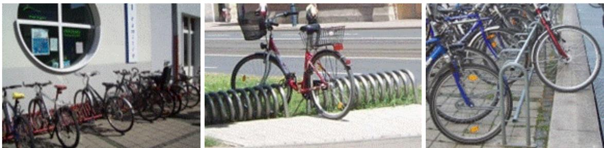
Abb. 11: Fahrradständer in Jena – Beispiele für mangelhafte Ausführungen
