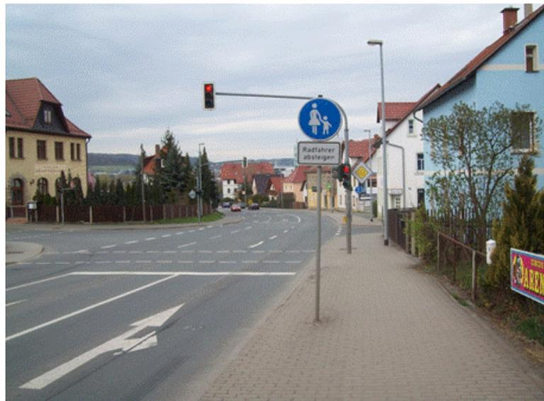
Hier sollte die Nachrüstung der Kreuzung mit einem aufgeweiteten Radaufstellstreifen, ggf. gekoppelt mit einem Schutzstreifen im Detail geprüft werden.
