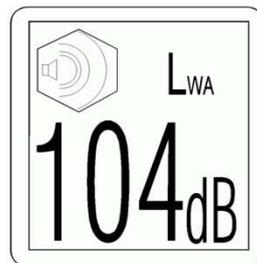
Normale Geräte weisen eine Schalleistung von ca. 89 dB(A) auf. Es gibt jedoch auch Geräte mit einem Schalleistungspegel von bis zu 115 dB(A).
